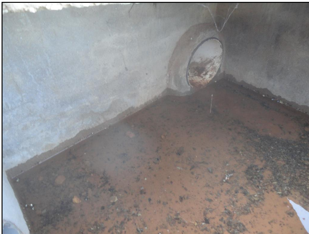
Figura 49 – Teste Hidráulico na caixa de passagem dos DAFA's para os Leitos de Secagem
