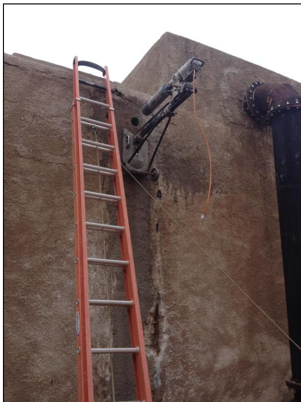
Figura 19 - Equipamento para extração dos corpos de prova
