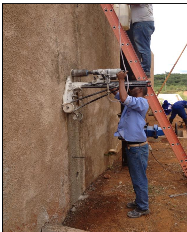
Figura 18 - Extração de corpos de prova
