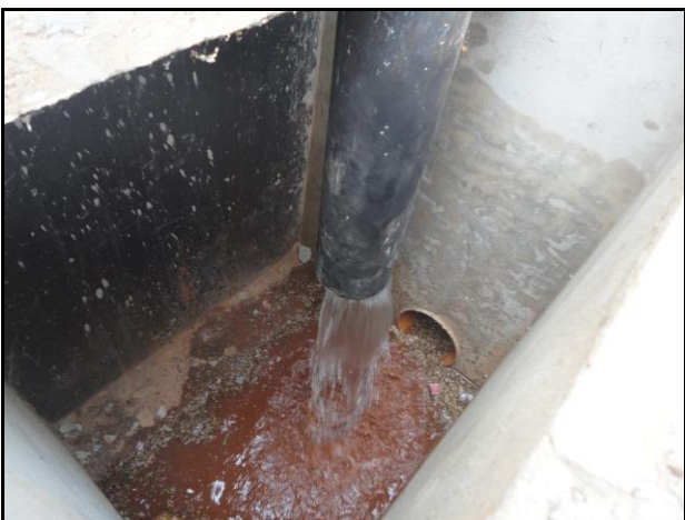
Figuras 40 e 41 – Execução do teste Hidráulico nos DAFA's
