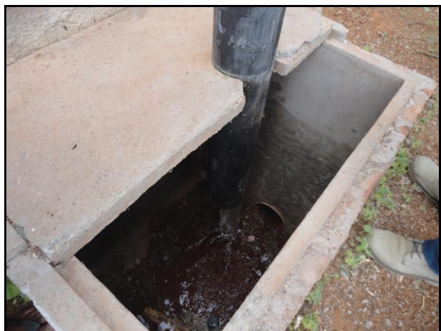
Figuras 40 e 41 – Execução do teste Hidráulico nos DAFA's
