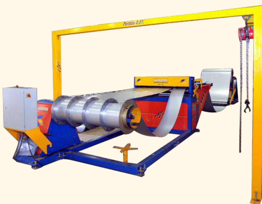
Corte de chapa e de bobinas (slitter) Bobinas de até 1 m de largura
