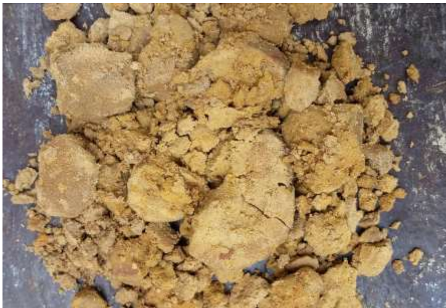
FURO: SPT 01 - NÚMERO DA AMOSTRA: 03/05 - PENETRAÇÃO: 1,00 à 1,45m DESCRIÇÃO: Silte argiloso, mole de cor creme amarelado claro com veios creme amarelado escuro. De 0,84 à 1,57m.
