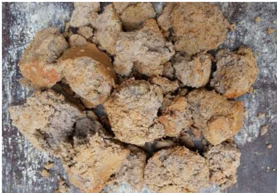
FURO: SPT 01 - NÚMERO DA AMOSTRA: 05/05 - PENETRAÇÃO: 3,00 à 3,25m DESCRIÇÃO: Argila medianamente a muito siltosa, rija de cor variegada com predominância de cinza claro e creme avermelhado escuro. De 1,57 à 3,25m.
