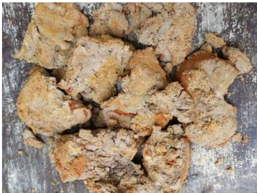
FURO: SPT 01 - NÚMERO DA AMOSTRA: 04/05 - PENETRAÇÃO: 2,00 à 2,45m DESCRIÇÃO: Argila medianamente a muito siltosa, rija de cor variegada com predominância de cinza claro e creme avermelhado escuro. De 1,57 à 3,25m.
