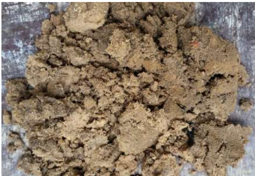
FURO: SPT 02 - NÚMERO DA AMOSTRA: 01/05 - PENETRAÇÃO: 0,00 à 0,45m DESCRIÇÃO: Areia muito fina, medianamente a muito siltosa, fofa de cor cinza claro escuro com veios creme escuro. De 0,00 à 0,84m.
