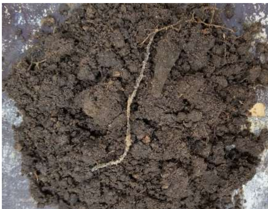
FURO: SPT 04 - NÚMERO DA AMOSTRA: 01/02 - PENETRAÇÃO: 0,00 à 0,36m DESCRIÇÃO: Silte arenoso, fofo de cor escuro com presença acentuada de entulho e lixo doméstico. De 0,00 à 0,36m. Aterro.
