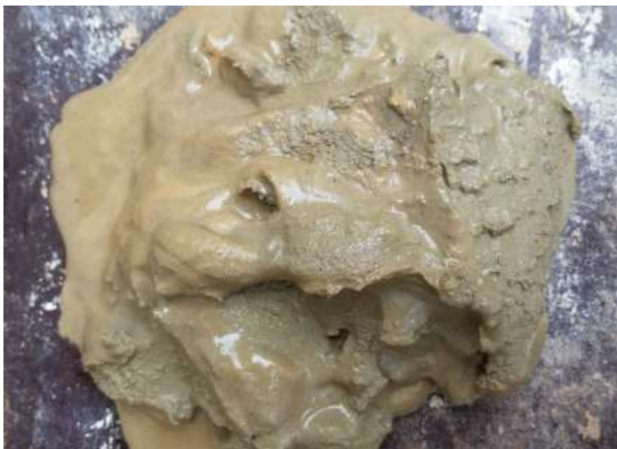
FURO: SPT 02 - NÚMERO DA AMOSTRA: 03/05 - PENETRAÇÃO: 2,00 à 2,45m DESCRIÇÃO: Silte muito argiloso, muito mole à mole de cor creme escuro. De 0,84 à 2,77m.
