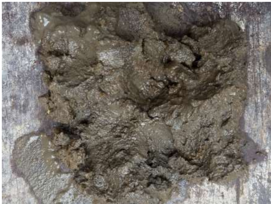
FURO: SPT 03 - NÚMERO DA AMOSTRA: 01/03 - PENETRAÇÃO: 0,00 à 0,45m DESCRIÇÃO: Silte muito argiloso, mole de cor escuro. De 0,00 á 0,64m.
