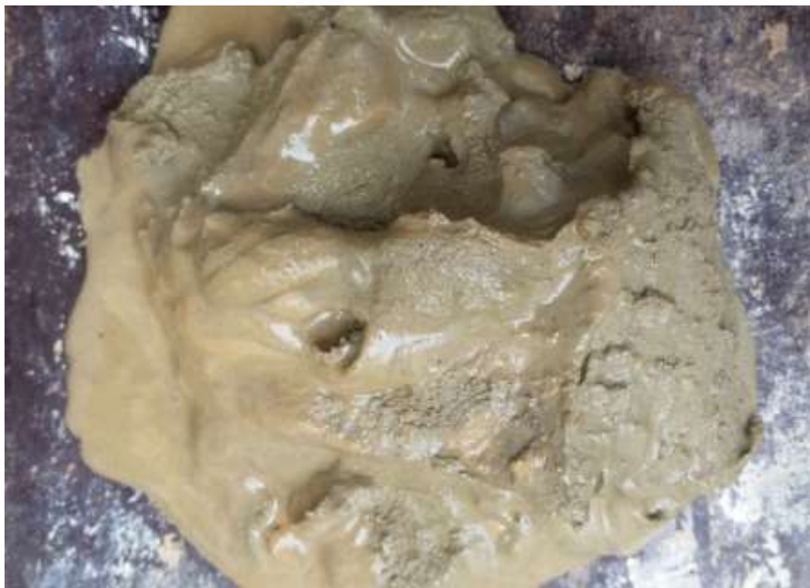
FURO: SPT 02 - NÚMERO DA AMOSTRA: 02/05 - PENETRAÇÃO: 1,00 à 1,96m DESCRIÇÃO: Silte muito argiloso, muito mole à mole de cor creme escuro. De 0,84 à 2,77m.
