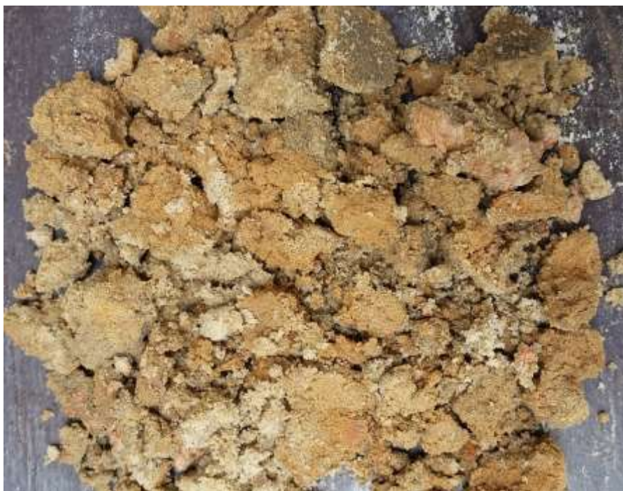
FURO: SPT 01 - NÚMERO DA AMOSTRA: 02/05 - PENETRAÇÃO: 0,43 à 0,84m DESCRIÇÃO: Areia muito fina, pouco a medianamente siltosa, fofa de cor creme escuro avermelhado com veios cinza claro. De 0,43 à 0,84m.
