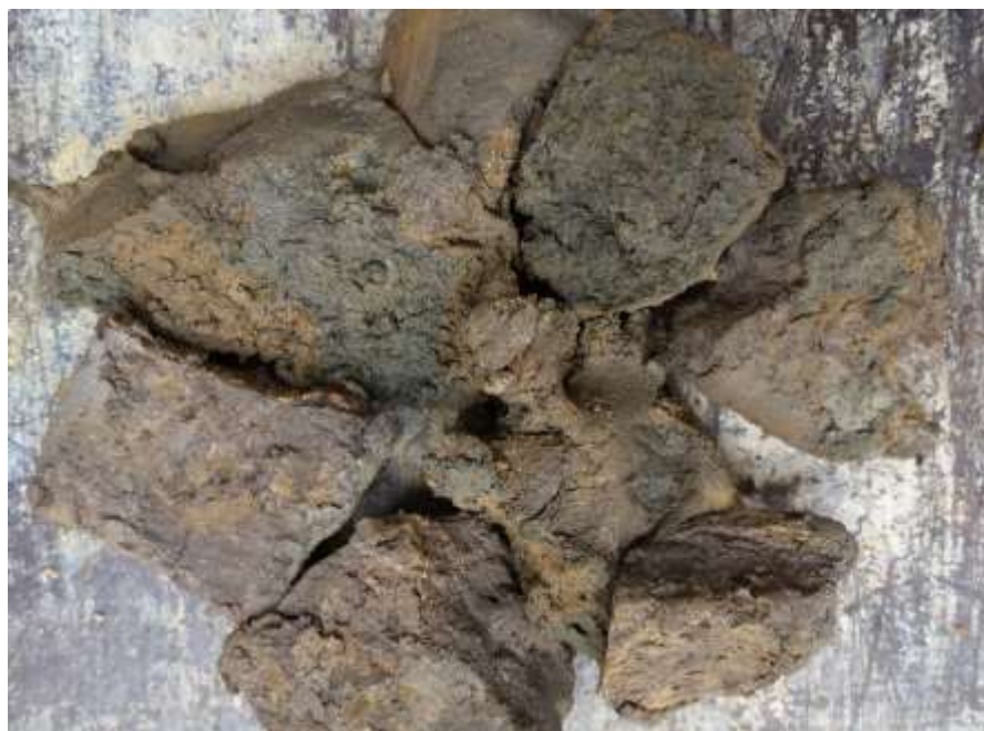
FURO: SPT 03 - NÚMERO DA AMOSTRA: 02/03 - PENETRAÇÃO: 0,60 à 1,15m DESCRIÇÃO: Argila medianamente a muito siltosa, mole e cor escuro. De 0,64 à 1,15m.
