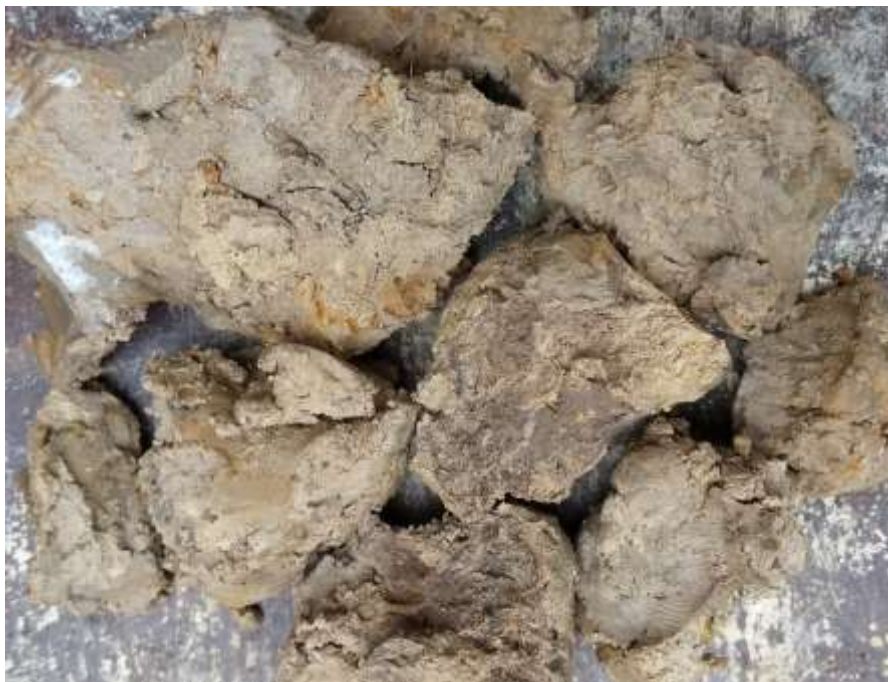
FURO: SPT 03 - NÚMERO DA AMOSTRA: 03/03 - PENETRAÇÃO: 1,15 à 1,45m DESCRIÇÃO: Argila plástica, pouco a medianamente siltosa, mole à medianamente consistente de cor cinza claro com veios creme amarelado. De 1,15 à 2,89m.
