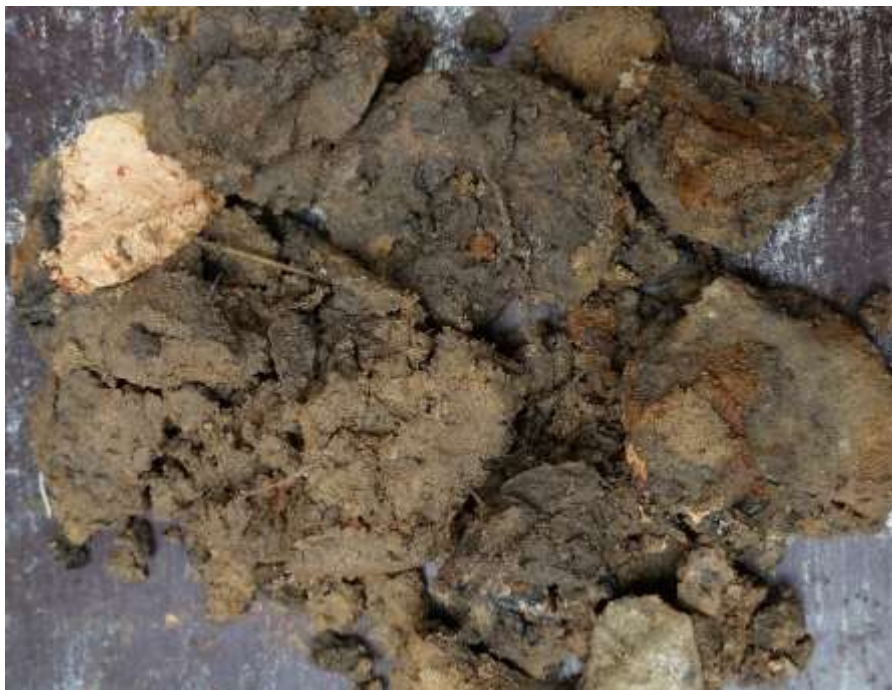
FURO: SPT 01 - NÚMERO DA AMOSTRA: 01/05 - PENETRAÇÃO: 0,00 à 0,43m DESCRIÇÃO: Areia muito fina, pouco siltosa, fofa a pouco compacta de cor escura e veios creme escuro amarelado com presença acentuada de entulho. De 0,00 à 0,43m. Aterro.
