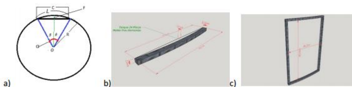
Figura 1. a) Representação da circunferência do tanque com os indicadores usados no cálculo das medidas da forma. L (Arco); C (Corda); R (Raio); F (Flexa); \alpha (ângulo central); \theta semi-ângulo central; o (origem) b) Representa a peça e a indicação das medidas para fabricação da forma e c) a forma com suas medidas internas.
