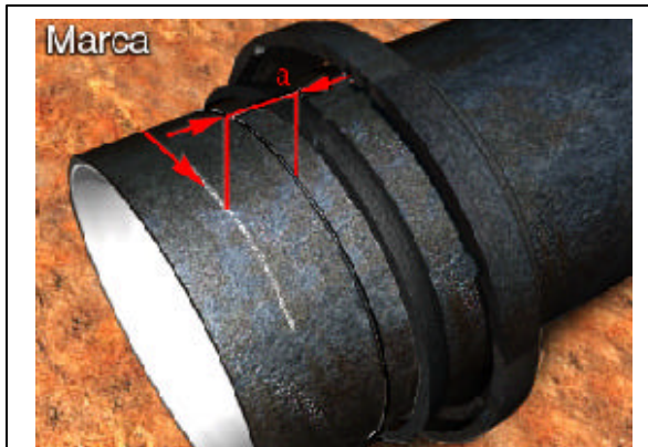
Fig. 06 - Marcação da profundidade de penetração
