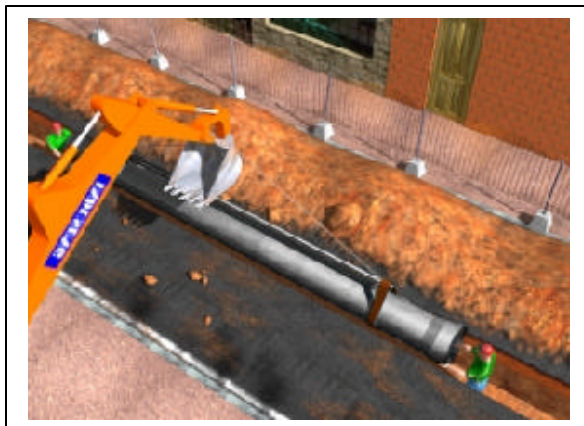
Fig. 05 - Colocação do tubo na vala
