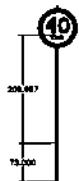
DETALHE 1: POSICIONAMENTO DAS PLACAS DIMENSÕES DA PLACA DE ADVERTÊNCIA FIXAÇÃO EM CONCRETO ESTRUTURAL SEMI-REFLETIVA
